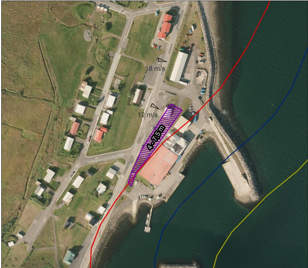
Mynd 22. Tillögur að varnargörðum. Áætluð hæð garða og hraði hönnunarflóðs eru sýnd. Hættumatslínur eru A gular, B bláar og C rauðar. Loftmynd: Loftmyndir ehf.
