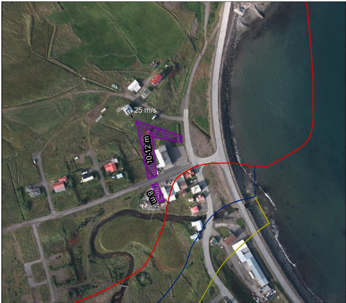
Mynd 17. Tillögur að varnargörðum í Hnífsdal. Áætluð hæð garða og hraði hönnunarflóðs eru sýnd. Hættumatslínur eru A gular, B bláar og C rauðar. Loftmynd: Loftmyndir ehf.
