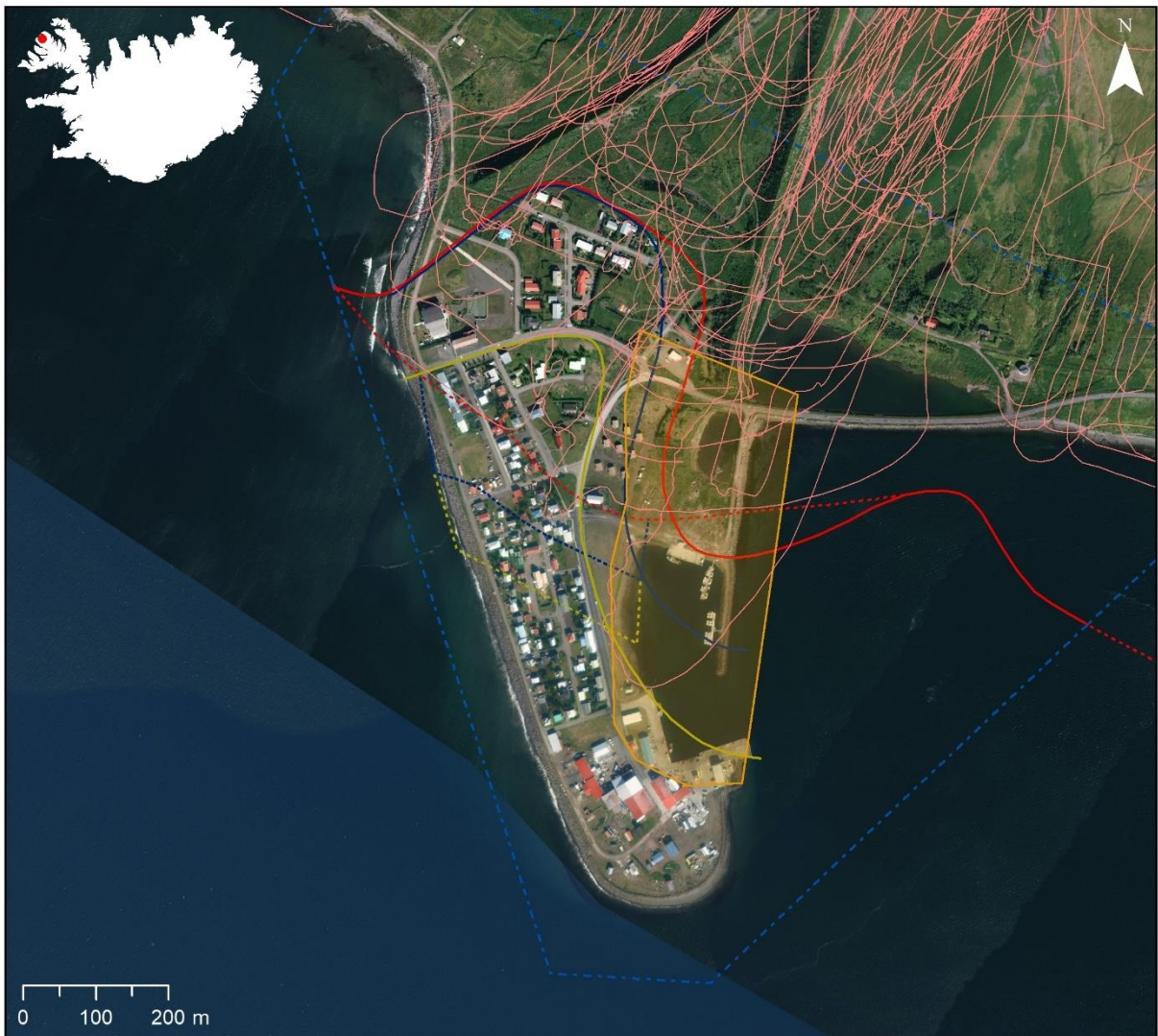
Mynd 14: C-svæði við höfnina á Flateyri afmarkað með appelsínugulu. Hættumatslínur eru A gular, B bláar og C rauðar, mörk hættumetins svæðis eru sýnd með blárri strikalínu og þekktar útlínur snjóflóða eru sýndar með bleikum línur. Loftmynd: Loftmyndir ehf.
