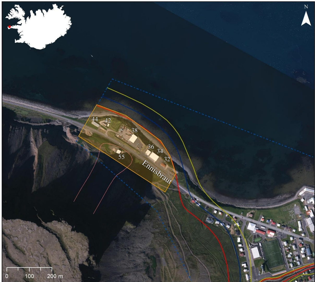
Mynd 6: Atvinnusvæði á C-svæði undir Ólafsvíkurenni afmarkað með appelsínugulu. Hættumatslínur eru A gular, B bláar og C rauðar, mörk hættumetins svæðis eru sýnd með blárri strikalínu og þekktar útlínur snjóflóða eru sýndar með bleikum línun. Loftmynd: Loftmyndir ehf.
