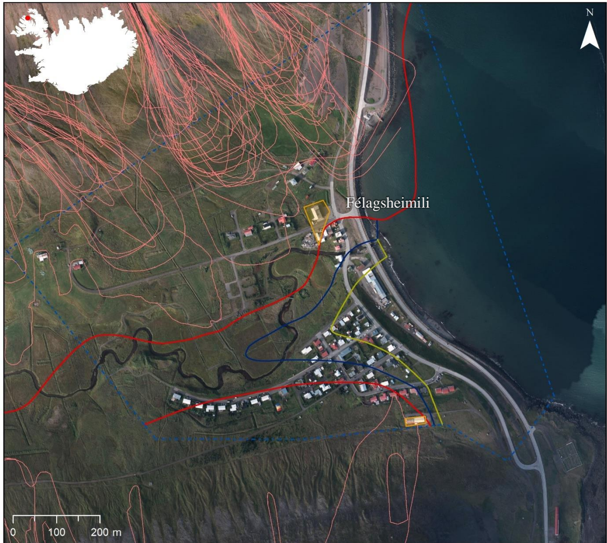
Mynd 16. Atvinnuhúsnæði á C-svæði í Hnífsdal afmarkað með appelsínugulu. Hættumatslínur eru A gular, B bláar og C rauðar, mörk hættumetins svæðis eru sýnd með blárrí strikalínu og þekktar útlínur snjóflóða eru sýndar með bleikum línum. Loftmynd: Loftmyndir ehf.
