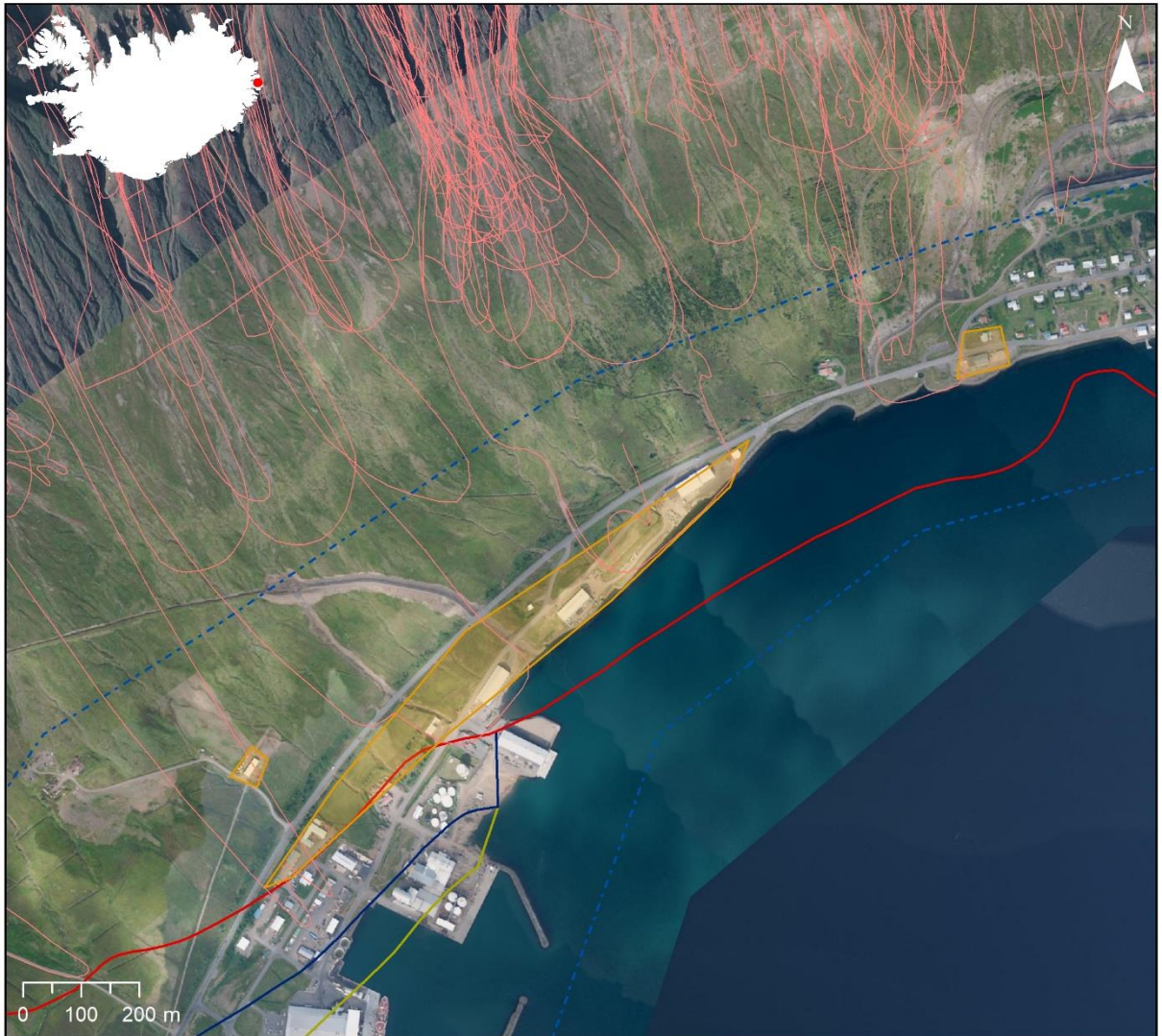
Mynd 30. Atvinnuhús á C-svæðum innan íbúðarbyggðarinnar í Neskaupstað afmörkuð með appelsínugulu. Hættumatslínur eru A gular, B bláar og C rauðar, mörk hættumetins svæðis eru sýnd með blárri strikalínu og þekktar útlínur snjóflóða eru sýndar með bleikum línum. Loftmynd: Loftmyndir ehf.
