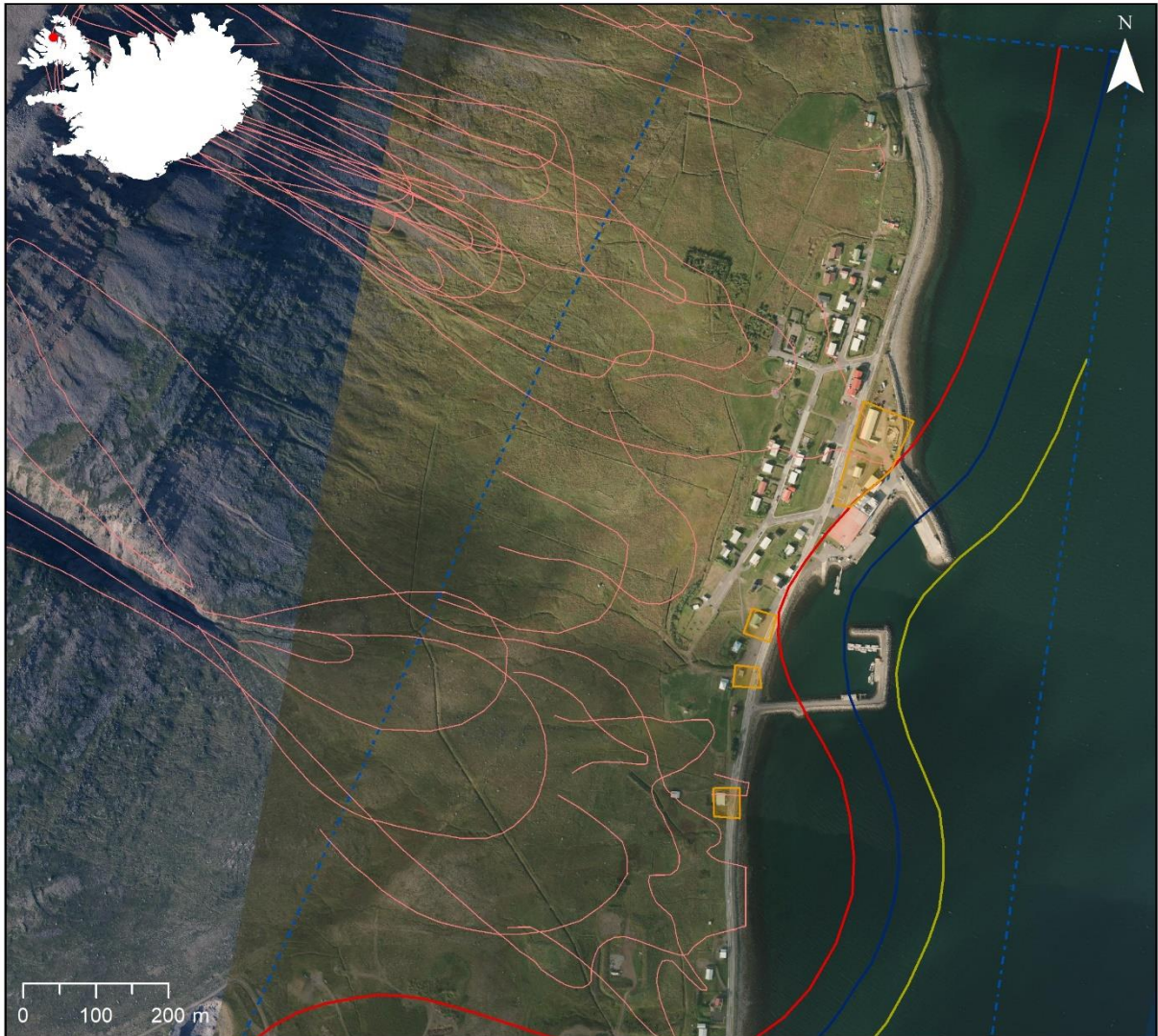
Mynd 21. Atvinnuhús á C-svæði í Súðavík afmörkuð með appelsínugulu. Hættumatslínur eru A gular, B bláar og C rauðar, mörk hættumetins svæðis eru sýnd með blárrí stríkalínu og þekktar útlínur snjóflóða eru sýndar með bleikum línunum. Loftmynd: Loftmyndir ehf.
