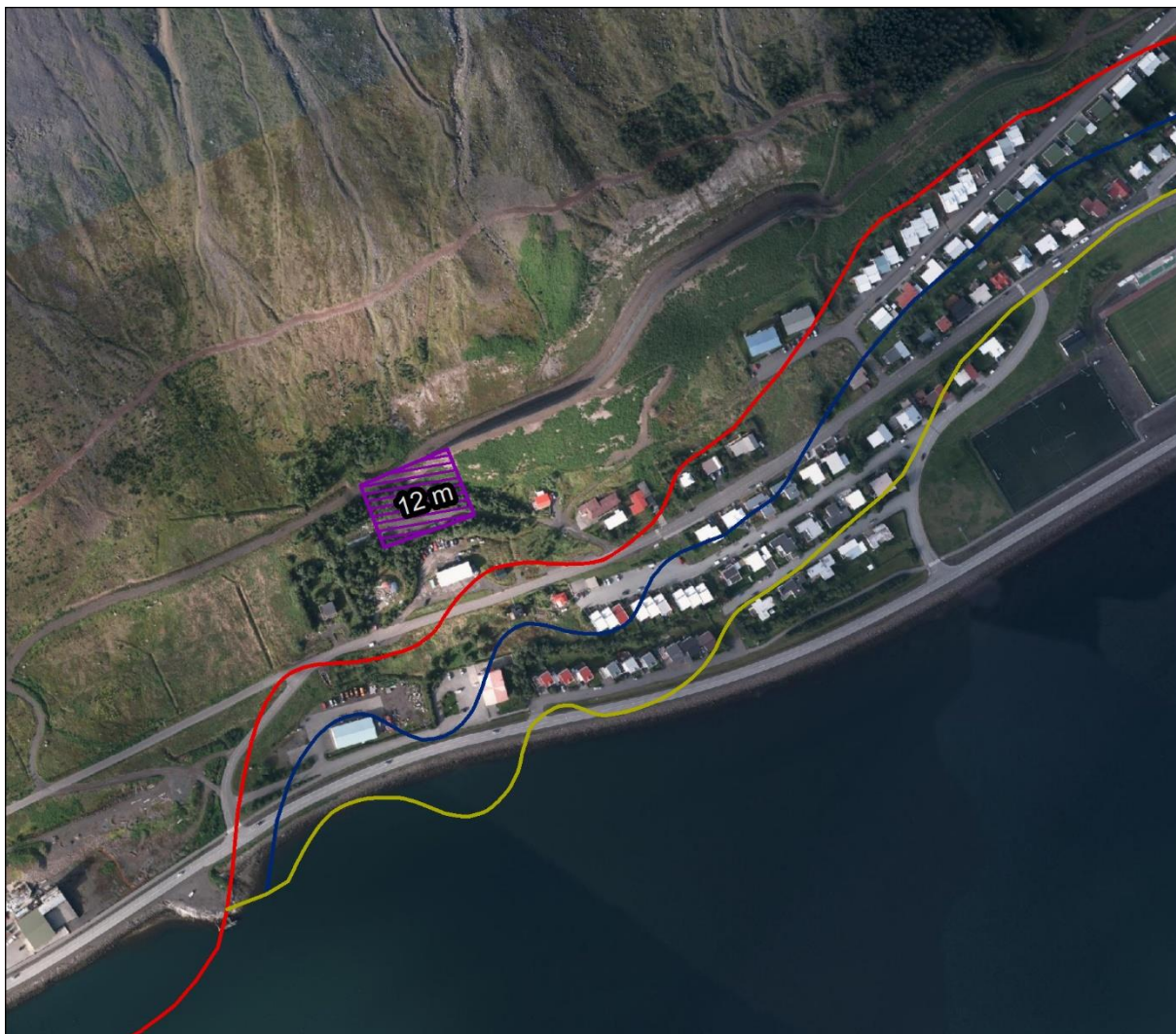
Mynd 20. Tillögur að varnargarði ofan verkstæðis á Ísafirði. Áætluð hæð garðs er sýnd á myndinni. Hættumatslínur eru A gular, B bláar og C rauðar. Loftmynd: Loftmyndir ehf.
