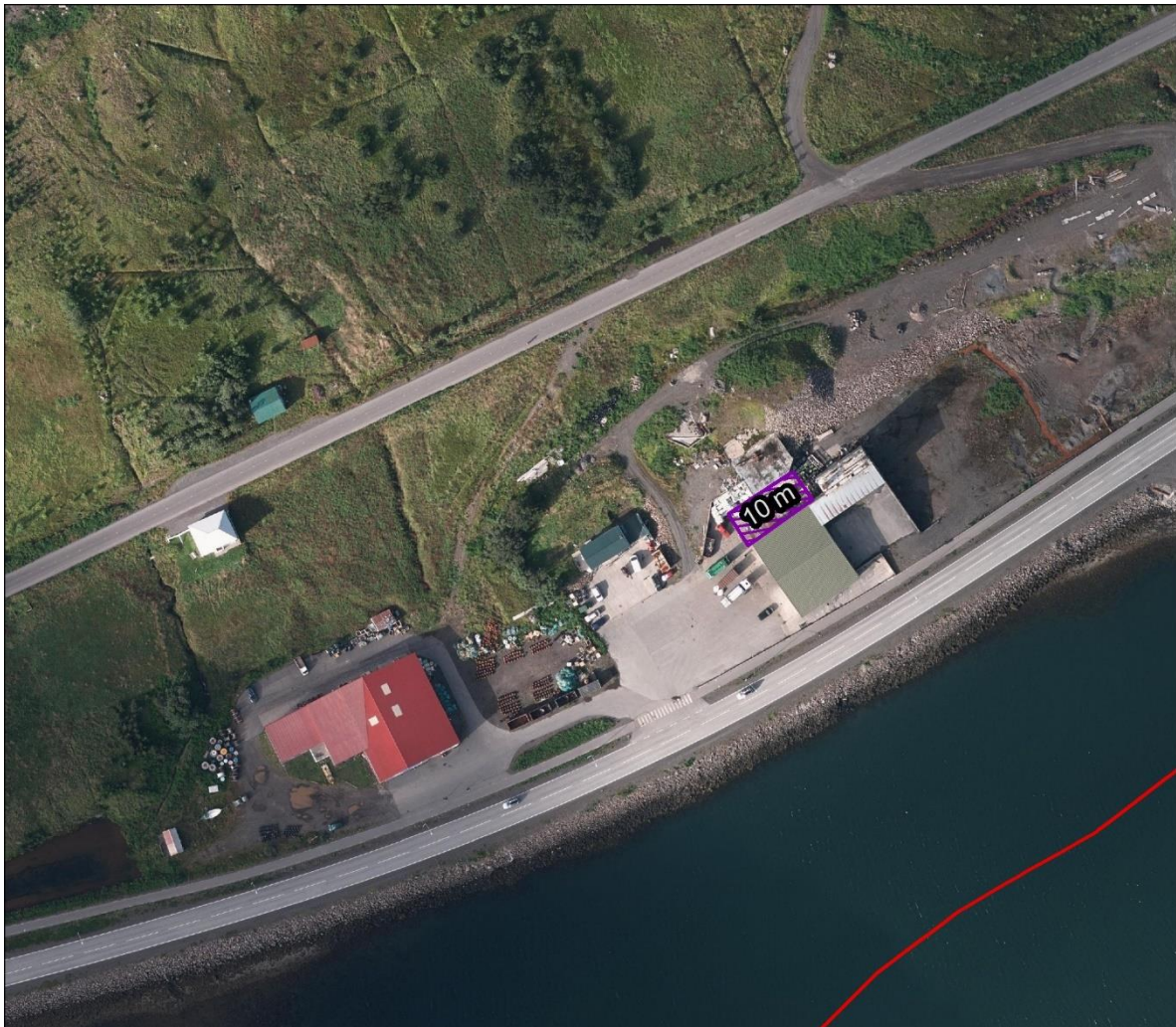
Mynd 19. Tillögur að varnargarði ofan steiniðju á Ísafirði. Áætluð hæð garðs er sýnd á myndinni. Hættumatslínur eru A gular, B bláar og C rauðar. Loftmynd: Loftmyndir ehf.
