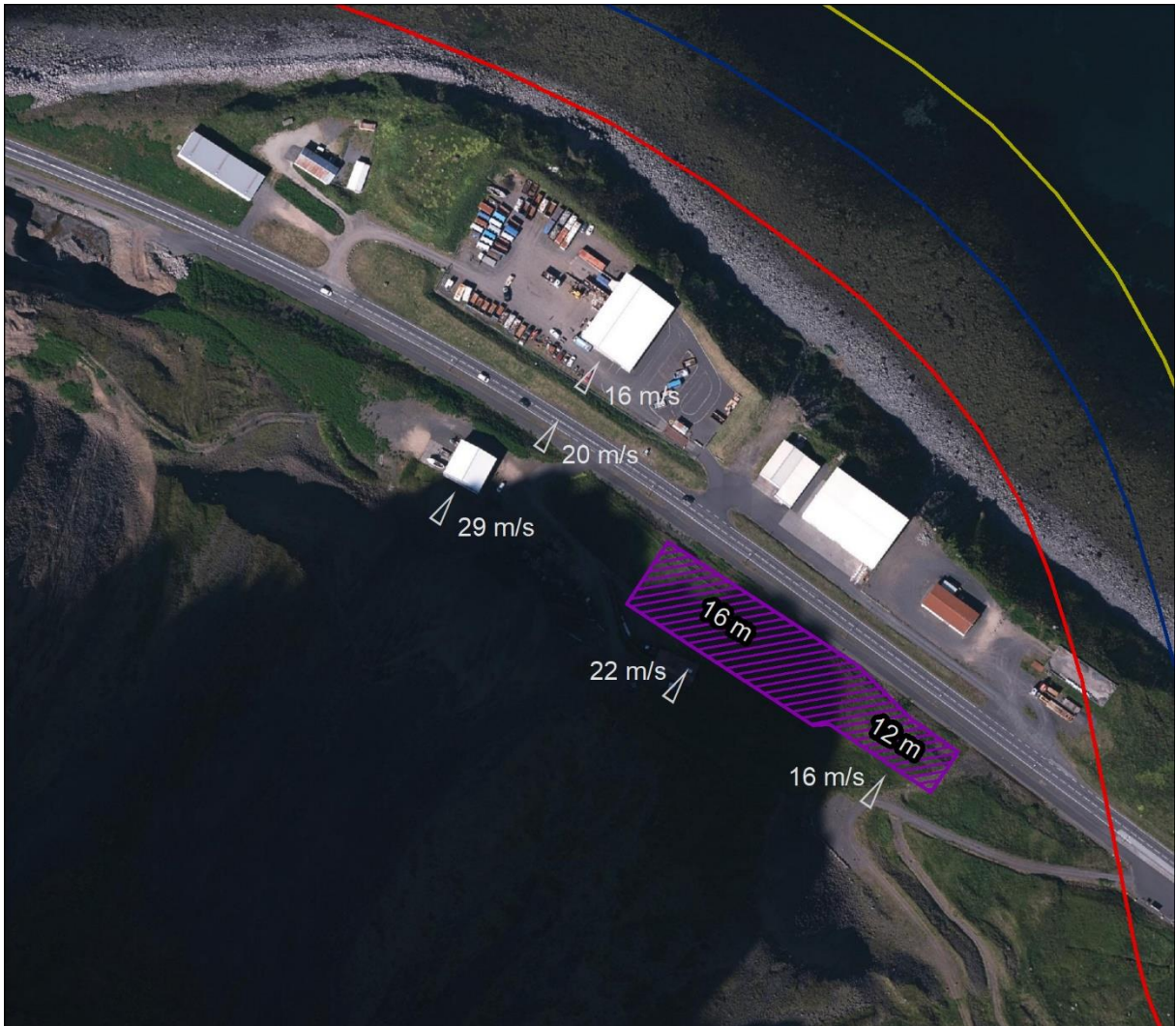
Mynd 7. Tillögur að varnargörðum. Áætluð hæð garða og hraði hönnunarflóðs eru sýnd. Hættumatslínur eru A gular, B bláar og C rauðar. Loftmynd: Loftmyndir ehf.
