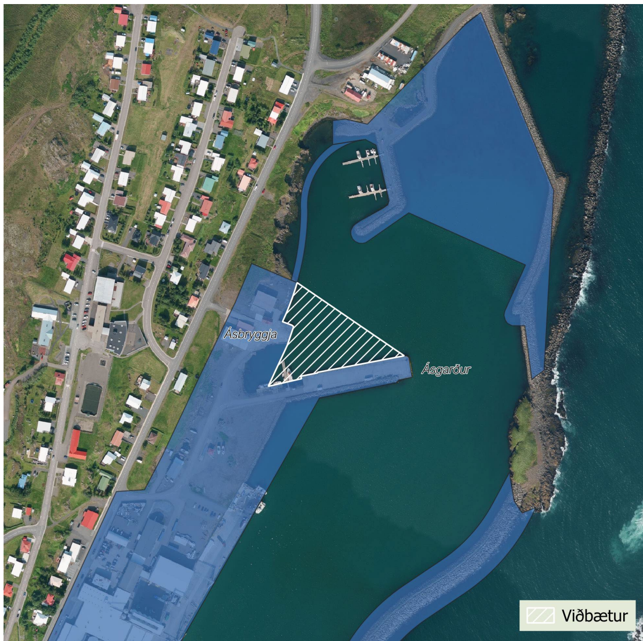
Mynd 4:3 Tillaga A fyrir hafnarsvæðið, landfylling við Ásbryggju og Ásgarð.
